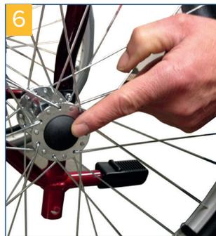
Dazu halten Sie mit einer Hand den Transport Rollstuhlrahmen, die andere Hand fasst die Mitte des Rades. Drücken Sie den Stift in der Mitte nach innen und ziehen Sie mit der gleichen Bewegung die Radnabe vom Rad weg (**Bild 6**).
