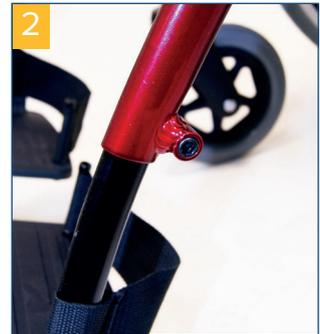
La sedia a rotelle per trasporto è dotata di un meccanismo per abbassare la metà superiore della spalliera, in modo da poter riporre la sedia in uno spazio ridotto grazie alla minore altezza (**fig. 3**).
