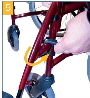
Zum Abnehmen der Beinstütze schwenken Sie diese um etwa 45° nach außen und ziehen sie nach oben ab.
